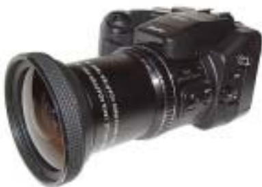
改裝後的 raynox 6600 系列廣角鏡頭可直接裝於 S602Z 的 山哥套筒 上
