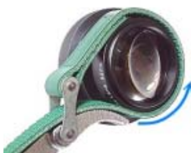
轉不開 raynox 6600 系列轉接環時可用 綁帶扳手 來拆卸
