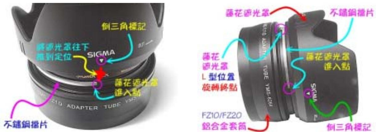
5 · 蓮花遮光罩從進入點往下推到定位後，先用手掌握住蓮花遮光罩順時鐘旋轉若覺得緊時，再用手輕抓住蓮花遮光罩的單片大花瓣處（上下皆可），繼續以順時鐘方向即可輕易轉到擋片的” L 型位置處；再檢查蓮花遮光罩的倒三角標記是否有對準相機上方的正中間。
